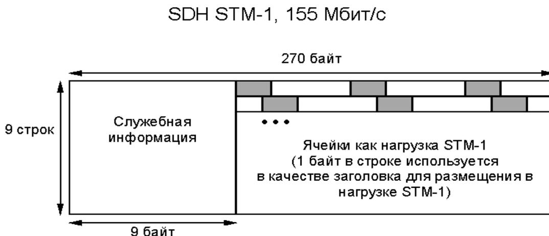
Рис. 2.2. Пример формирования потока SDH STM-1, 155 Мбит/с
