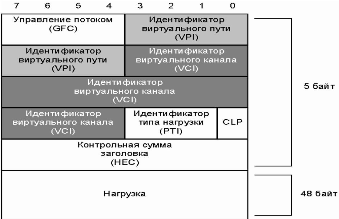
Рис. 2.3. Структура заголовка ячейки АТМ
